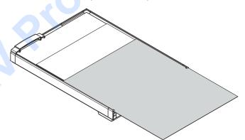
Il pannello può essere sostituito anche con un altro di diverso spessore. Lo spessore può variare da 0.8 a 3 mm. The panel can also be replaced with one of a different thickness. The thickness can vary from 0.8 to 3 mm
