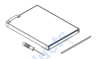
Rimuovere uno o entrambi i pannelli e sostituirli Remove one or both panels and replace them
